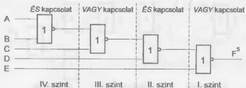
4.19. ábra. Többszintű logikai hálózat NOR kapukkal
