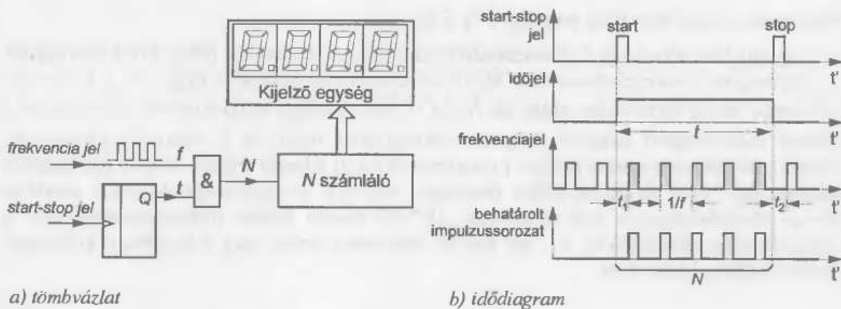
7.29. ábra. A digitális frekvencia- és időmérés elve
