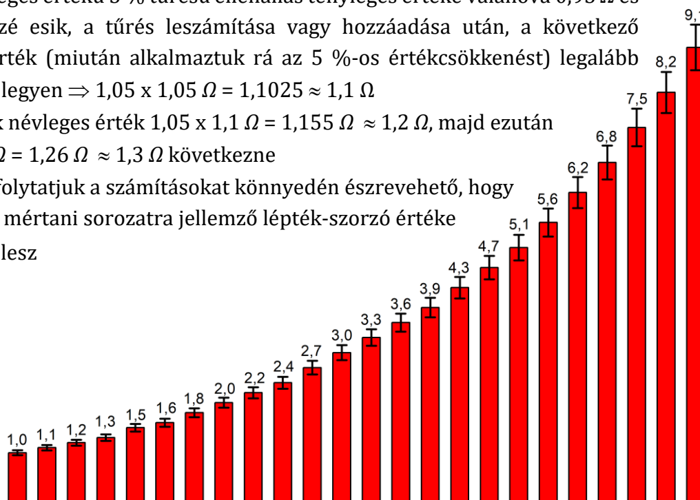
9.1 ábra – Az E24 értéksor alapértékei és tűrésük
