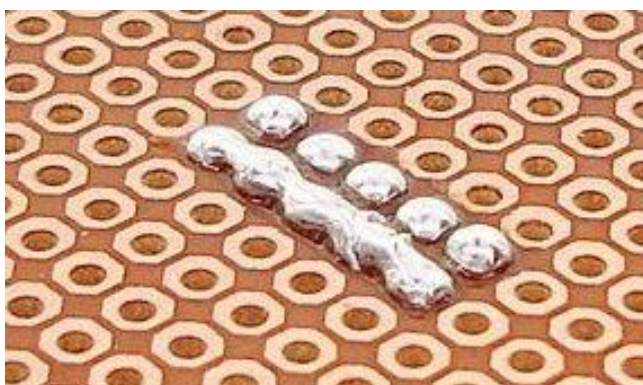
14.1 ábra – Forrasztható rézfólia forrasztási pontokkal és hosszúforrasztással
