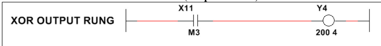
11.2. ábra A teljes XOR kimeneti létrafok.
