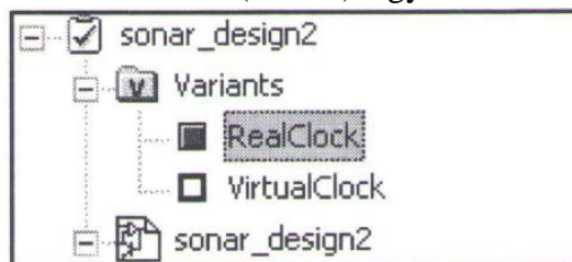
8.6. ábra Az aktív változat (Active Variant) beállítása terv eszköztár (Design Toolbox) segítségével.
